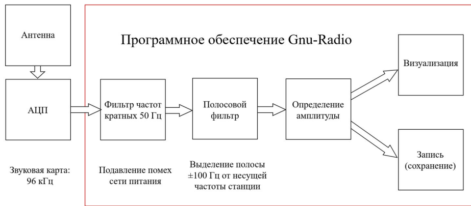
Рис. 1. Схема программно определяемого ОНЧ-приемника
