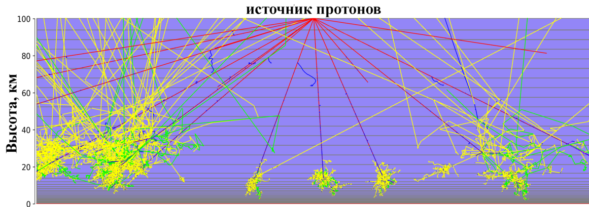
Рис. 1. Пример моделирования прохождения частиц первичных и вторичных КЛ через атмосферу Земли с использованием модели RUSCOSMICS, показана лишь одна проекция геометрии атмосферы. На рисунке представлены геометрия атмосферы в «плоском» приближении, источник первичных протонов, определенный как точечный с изотропным угловым распределением, а также трекинг вторичных частиц. Атмосфера разделена на слои с одинаковым процентным содержанием воздуха и параметризованная при помощи модели NRLMSISE-00 [Picone et al., 2002]. Красными линиями показаны положительно заряженные частицы, синими — отрицательно, зелеными — нейтроны, желтыми — фотоны
