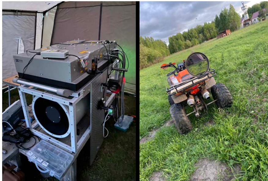
Рис. 2. Мобильный ИК-лидар (а); б — зеркальный отражатель для проверки соосности красного (630 нм) и ИК-пучков (3428.428 нм и 3431.708 нм) в дальней зоне и направление распространения лазерного излучения
