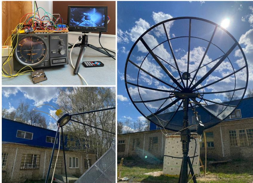
Рис. 1. Внешний вид разрабатываемого отечественного солнечного радиотелескопа на длине волны, близкой к 10.7 см
