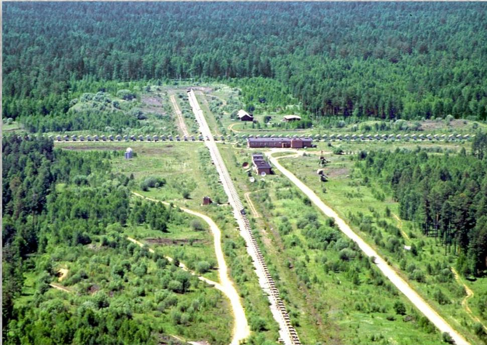
Создается на базе крупнейшего радиointерферометра России – 256-антенного Сибирского солнечного радиотелескопа, работающего на частоте 5.7 ГГц
