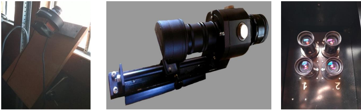
Рис. 1. Комплекс устройств, используемый в исследовании: фотометр (слева), ЭОП (посередине), быстрый четырехканальный фотометр (справа)
