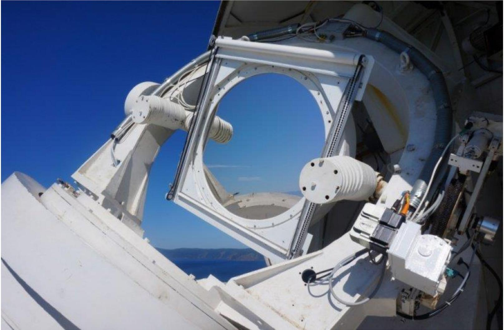
Модернизация за счет установки защитного средства зеркала (шторка).
