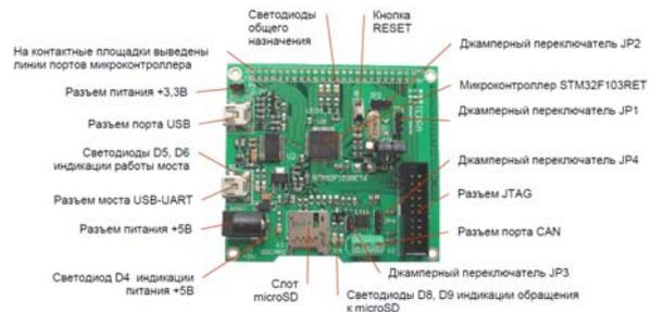
Рис. 2. Размещение элементов на верхней стороне платы TE-STM32F103
