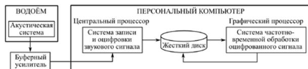
Рис. 1. Структурная схема системы регистрации геоакустической эмиссии.
