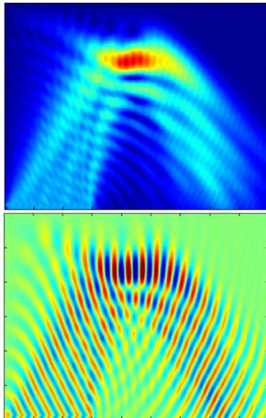
Рис 2. Наклонная падающая плоская волна попадает в вертикальный линейный слой. Вверху – распределение плотности энергии поля, внизу – мгновенное распределение поля. Среда без стокновительного поглощения.
