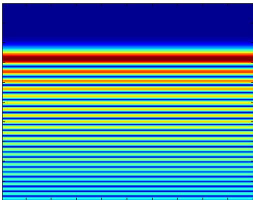
Рис 1. Распределение поля от вертикально падающей плоской волны в линейном слое. Функция отлична от функции Эйри вследствие вторичного отражения волны от источника.
