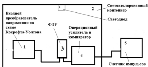
Рис. 4. Блок – схема установки фотометра.
