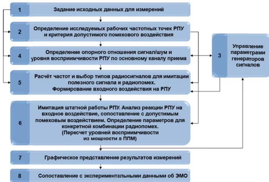
Обобщенная блок-схема метода оценки работоспособности РЛС с ФАР в условиях воздействия радиопомех вне основного канала приема.
