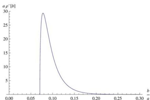
Рис. 2. Распределение  $\rho(b)$  в заднюю полусферу. Длина волны при  $z_0=1.01$  равна  $\lambda=0.889a$ . Минимальное значение параметра вылета  $b_0=0.071$ . Положение пика в распределении соответствует точке  $b/a \approx 0.09$ .
