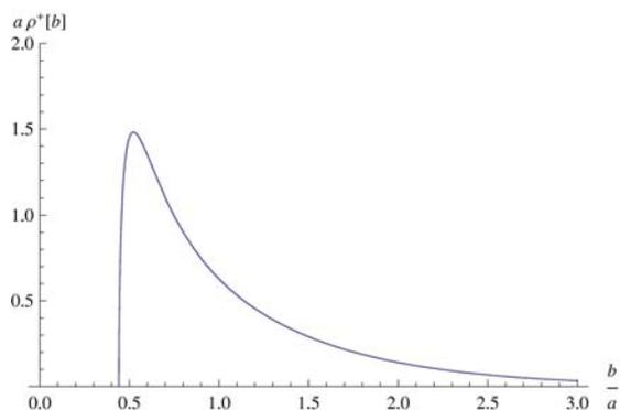
Рис. 1. Распределение  $\rho(b)$  в переднюю полусферу. Длина волны при  $z_0=1.39$  равна  $\lambda=5.549a$ . Минимальное значение параметра вылета  $b_0=0.442$ . Положение пика в распределении соответствует точке  $b/a \approx 0.6$ .
