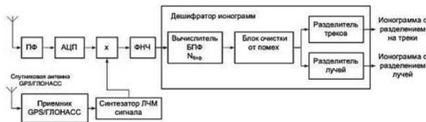
Рис. 1. Структурная схема цифрового приемника ЛЧМ-сигналов зондирования.
