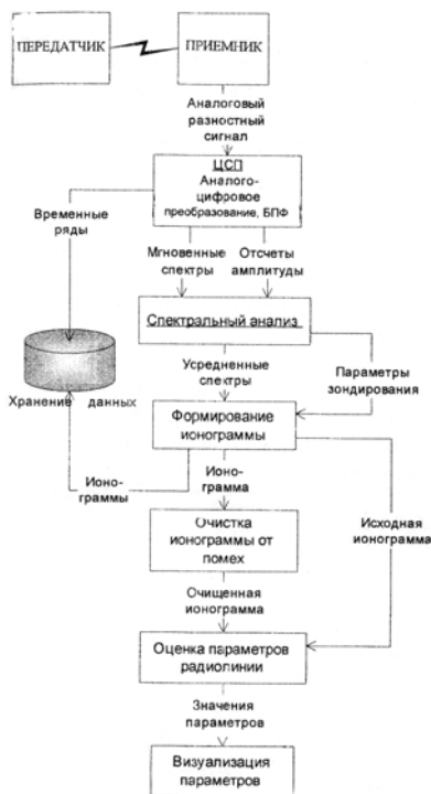
Рис. 2. Последовательность операций получения, накопления и обработки данных в приемном комплексе ЛЧМ-ионозонда.
