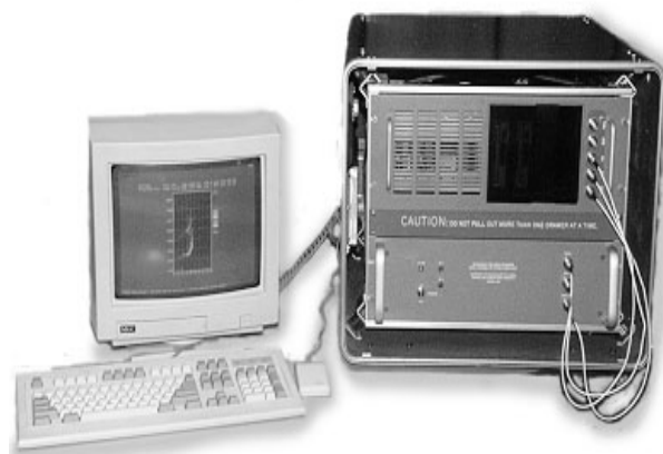
Рис. 3. Внешний вид основного блока и монитора дигизонда DPS-4.
